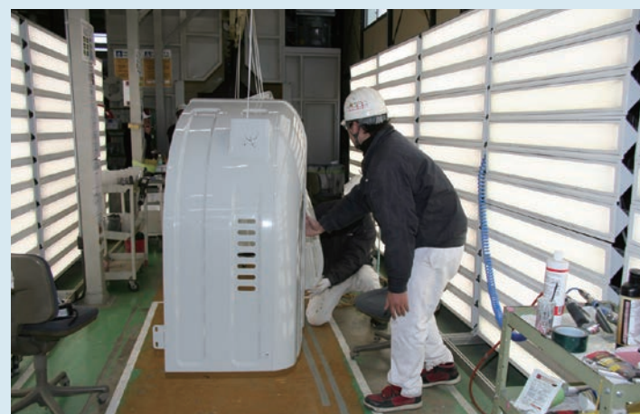
◀塗装品質の検査場 キズなどが分かりやすいようにLEDライトを使用する
