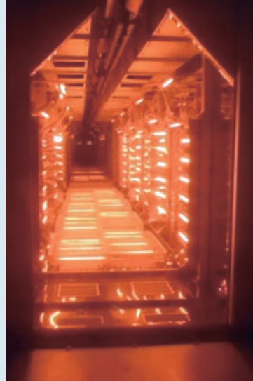
▲中波長赤外線ヒーターで効率的に乾燥
